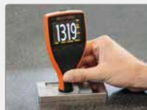
3. Cuando esté totalmente curado, calibre un medidor de espesor de revestimientos ferrosos al lado del molde CCM y luego mida y grabe el espesor de la película seca por el centro del revestimiento.
