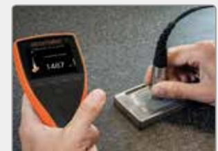
4. Mida el mismo punto empleando el Elcometer 500. Introduzca la medición del espesor de película seca y guárdela en la lista de materiales de revestimiento del Elcometer 500.
