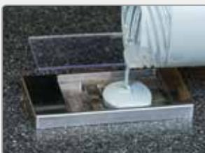
1. Coloque el molde de calibración del revestimiento (CCM) sobre una superficie plana y llene por completo la cámara de muestra con el revestimiento a comprobar.
