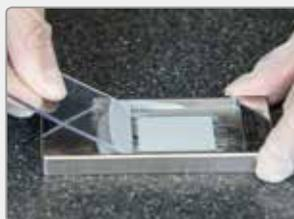
2. Empleando el raspador de plástico, raspe el revestimiento de manera que la cantidad sobrante caiga a la cámara de desbordamiento. Deje secar el revestimiento.
