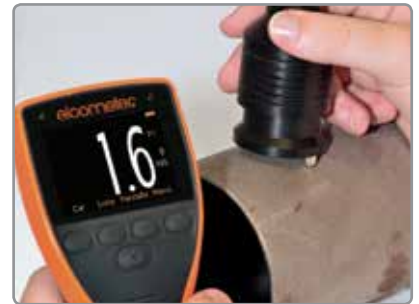
Las sondas integrales o separadas miden perfiles de hasta 500µm (20mils) en superficies planas o curvas**
